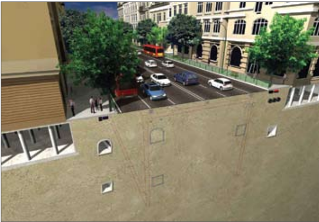
Рис. 3. I этап – перекладка коммуникаций
