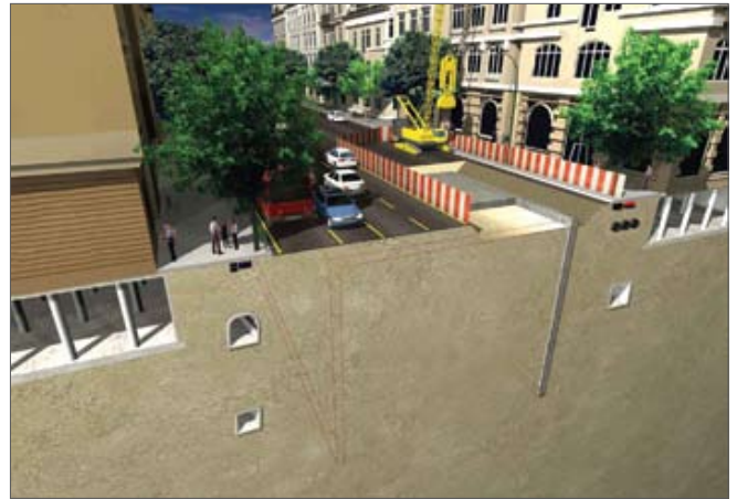
Рис. 4. II этап – перенос движения, сооружение стены в грунте и части плиты покрытия
