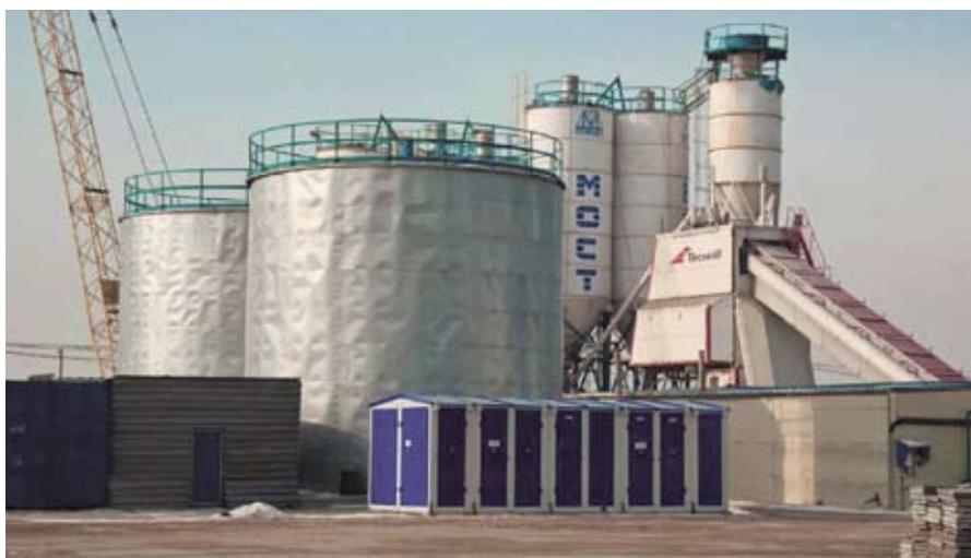
**Бетонный завод.** На острове Русский и полуострове Назимова расположены четыре мощнейших бетонных завода фирм «Tecwill Oy» и «Compactors», самый мощный из которых достигает производительности 160 м<sup>3</sup>/час
