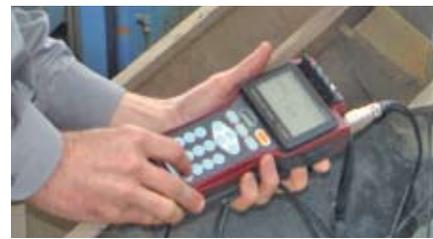
**Рис 2. Портативный тензометр ТС-32К**
