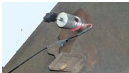
**Рис 1. Тензодатчик деформаций для мобильной экспресс-диагностики металлоконструкций**
