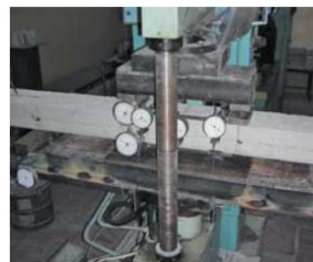
Рис. 3. Общий вид испытаний балки
