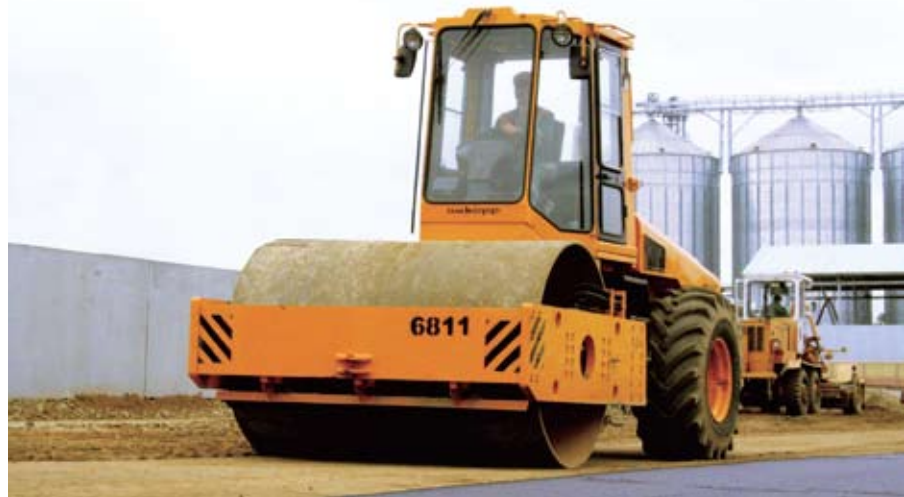
Рис. 2. Каток вибрационный самоходный АМКОДОР 6811
