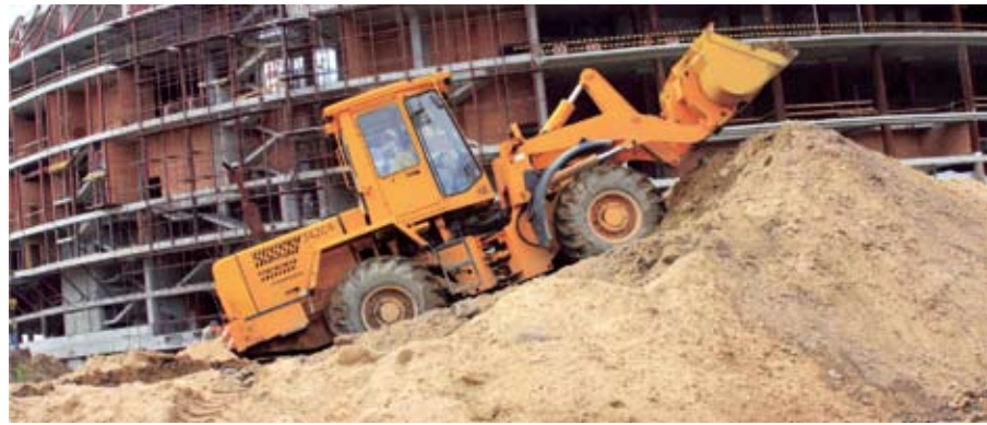
Рис. 1. Погрузчик универсальный АМКОДОР 342С4 с ковшом
