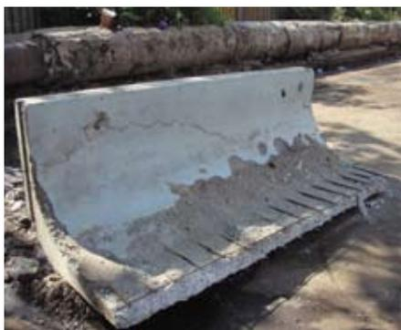
Фото 1. Шелушение бетона блока «Нью-Джерси» — результат применения паронепроницаемого покрытия.
