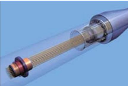
Для центрального пролетного строения применена усовершенствованная, так называемая «компактная» система PSS с более плотным размещением прядей в оболочке. Компактная конфигурация вант с использованием оболочки меньшего диаметра способствует снижению ветровой нагрузки на 25–30 процентов.
