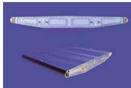
Конструкция пролетного строения имеет аэродинамическое сечение для восприятия нагрузок от шквалистого ветра. Конфигурация сечения пролета определена на основании аэродинамических расчетов и оптимизирована по результатам экспериментальной обработки масштабной модели на стадии рабочего проектирования.
