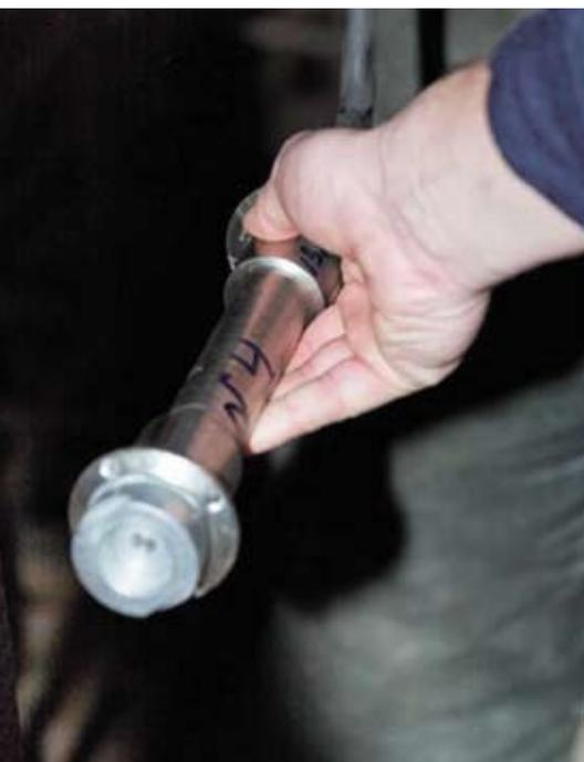
Рис.8. КИА, тензо-датчики напряжений установленные в тело ростверка
