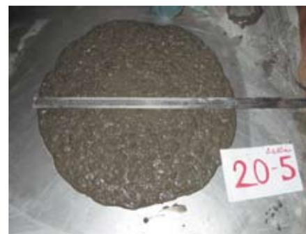
Рис.5. Расплыв бетонной смеси
