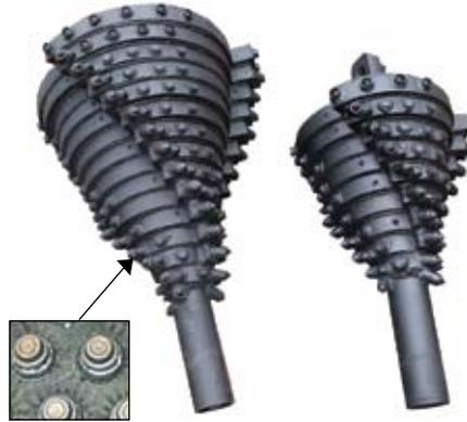
Режуще-уплотняющие расширители «Кодиак» с твердосплавными элементами TungStuds
