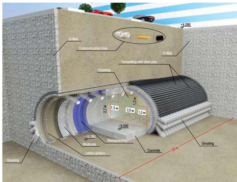
Рис. 2. Тоннель под автомобильной дорогой, сооружаемый по принципам, близким к НАТМ
