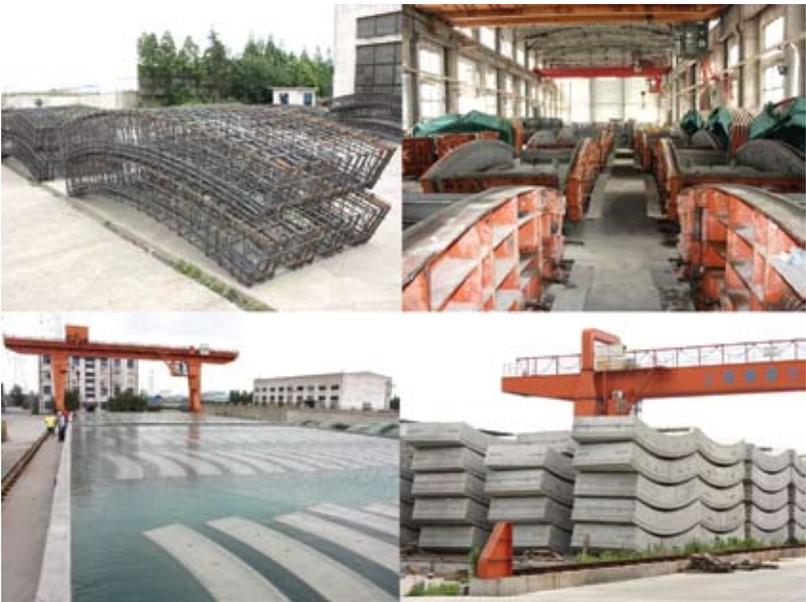
Рис. 4. Производство и хранение блоков тоннельной обделки Шанхайского тоннеля
