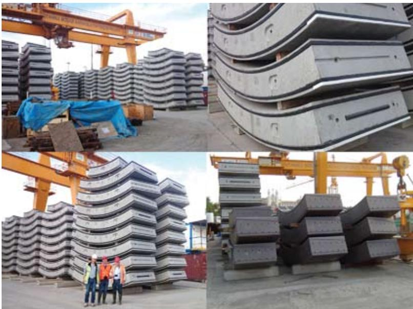
Рис. 3. Производство и хранение блоков тоннельной обделки Евразийского тоннеля
