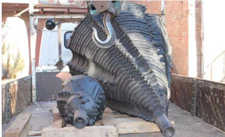
Режущо-уплотняющий расширитель «Компакт» (д.у. 1200 мм, масса 925 кг)
