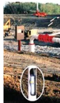
Уже более ста лет в шахтах применяются насосы компании Dichting (Германия). Как показывает практика, вместо ступенчатого перекачивания с яруса на ярус эффективнее использовать один насос, установленный на самой глубокой отметке шахты. Благодаря снижению количества насосов достигается экономия эксплуатационных расходов. Кроме того, использование одного (вместо нескольких перекачивающих) насоса последовательно один в другой более целесообразно с точки зрения энергосбережения.
