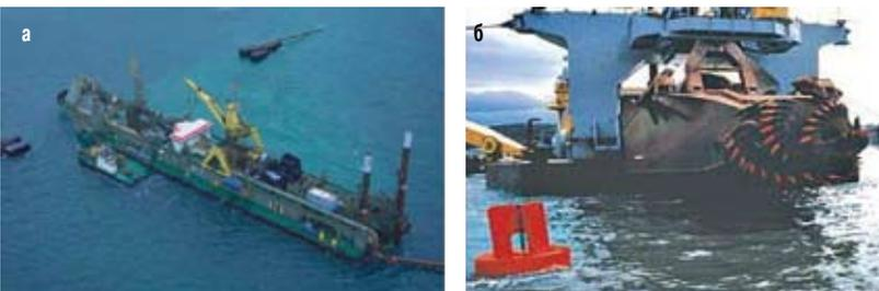
Рис. 9. Многофункциональная баржа с оборудованием для углубления и выравнивания траншей (а) и земснаряд для разработки твердых пород грунта (б)
