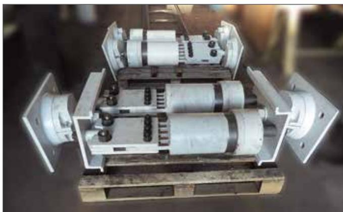
Демпфер-амортизатор на нагрузку 100 т
