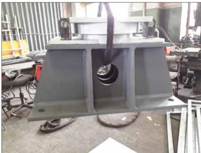
Контрольная сборка опорной части с переходной тумбой
