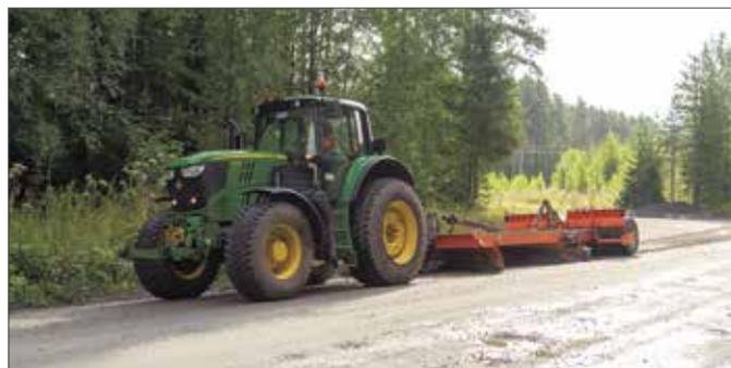
на чистую дорогу и с остатками снега после снегоуборки, а также выдержка обработанной дороги определенное технологическое время в безопасном состоянии и дальнейшее сгребание снега.
