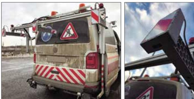
Рис. 4. Дорожная лаборатория, оборудованная программно-вычислительным комплексом и лазерно-оптическим сканером
