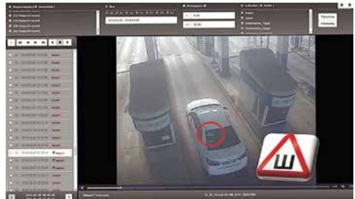
Рис. 3. Визуальная идентификация транспортных средств, оборудованных шипованными шинами
