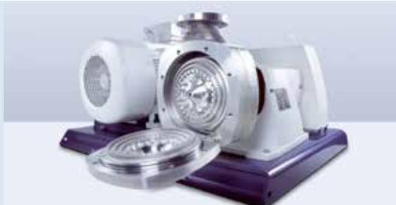
Мельницы SUPRATON® серии «S» предназначены для производства различного рода битумных эмульсий, в том числе модифицированных с использованием полимера SBS. Их отличительные черты – это высокая окружная скорость (до 50 м/сек), высокое качество эмульсии и большие срезающие силы, необходимые для получения стабильной продукции. Это особенно важно в случае использования для производства эмульсий материалов, плохо поддающихся эмульгированию, таких, как твердый битум или различного рода SBS и т. д.
