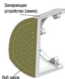
Рис. 25. Лоб забоя, приспособленный к закреплению с замком сзади
