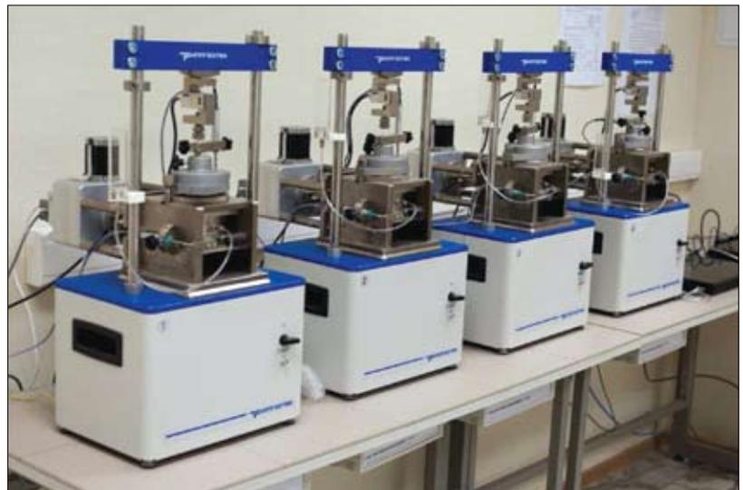
Рис. 4. Общий вид установок одноплоскостного среза
