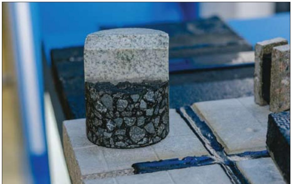
покрытия расход жидкой резины составляет от 3 до 10,5 кг/м<sup>2</sup>.
