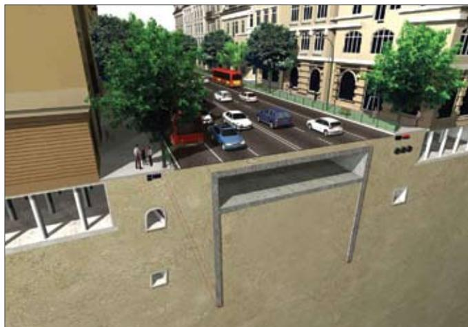
Рис. 6. IV этап – выемка грунта под плитой, устройство плиты вестибюля
