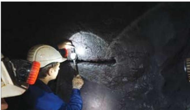
Рис. 2. Определение вертикальных напряжений методом щелевой разгрузки
