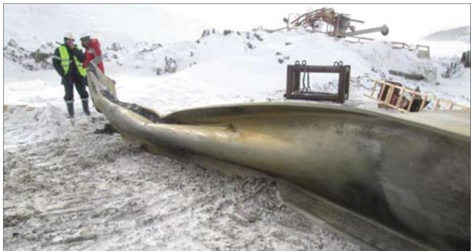
Рис. 1. Деформированный при забивке шпунт
