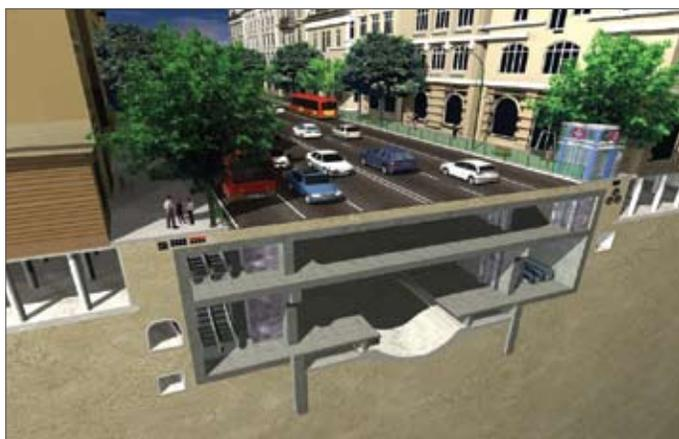
Рис. 7. V этап – сооружение платформ, архитектура и оборудование
