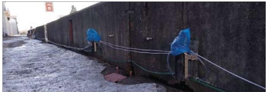
Рис. 3. Датчики гидростатического нивелирования системы «Мониторн ДГН-2», установленной на правой стороне шлюза
