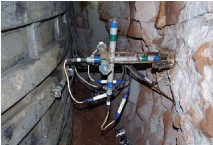
Рис. 8. Размещение деформометров в комбинированной крепи вертикального ствола
