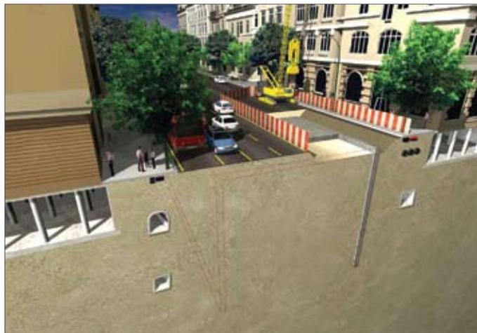
Рис. 4. II этап – перенос движения, сооружение стены в грунте и части плиты покрытия
