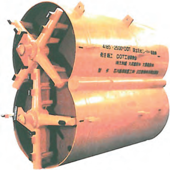
Рис. 1. Общий вид двухдискового МЩ вертикальной ориентации в виде сплошной или многолучевой планшайбы, оснащенной системой породоразрушающих инструментов, что позволяет создавать тоннельные выработки овоидального очертания [3].
