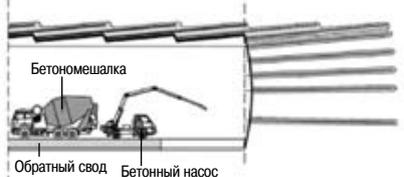
ЭТАП 8. Укладка гидроизоляции ПВХ и бетонирование постоянной обделки
