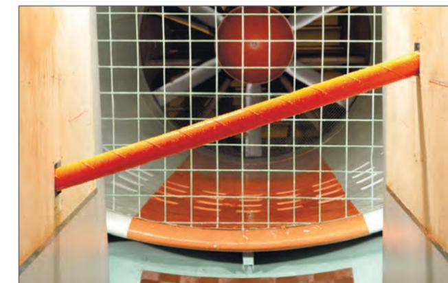
Рис. 6. Исследование устойчивости фрагмента ванты при наличии осадков
