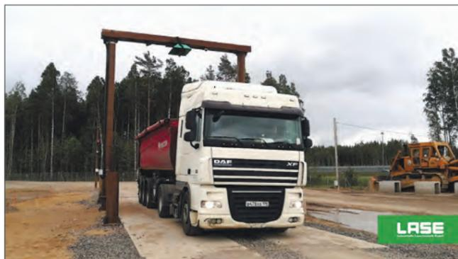
Рис. 1. Общий вид учетного КПП с одним лазерным 3D-сканером
