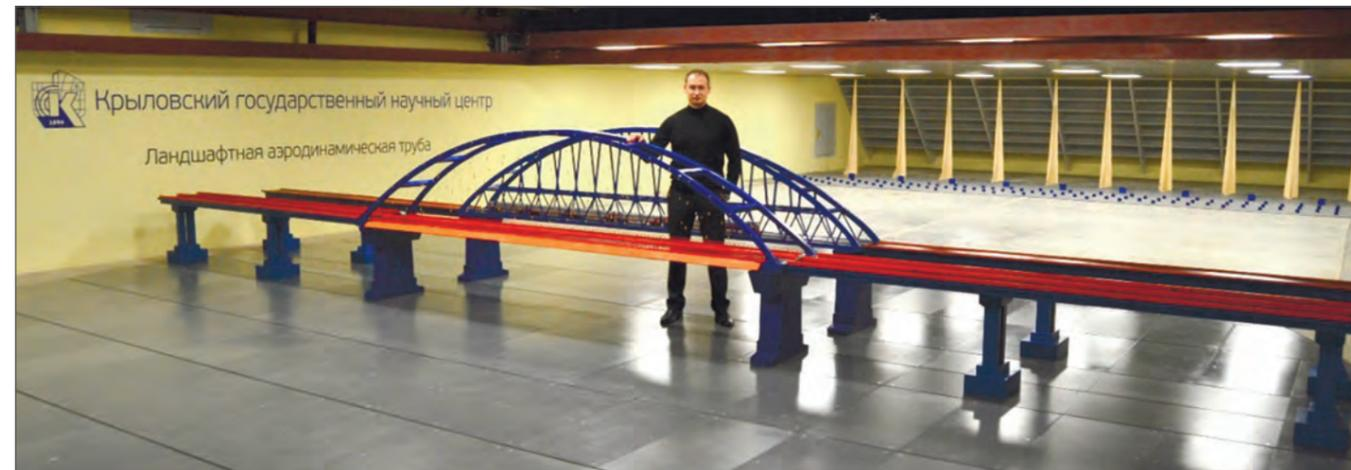
Рис. 4. Модель Крымского моста в рабочей части Ландшафтной аэродинамической трубы
