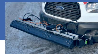
СИСТЕМА ПОДПОВЕРХНОСТНОГО ЗОНДИРОВАНИЯ
