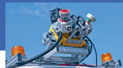
МОБИЛЬНАЯ ЛАЗЕРНАЯ СИСТЕМА (LIDAR)
