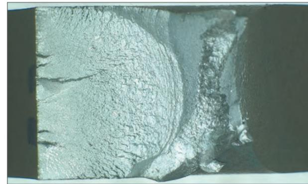
Рис. 5. Разрушение стандартного образца при испытании на выносливость. (фото авторов)
