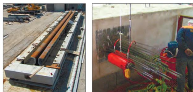
Стенд для изготовления а/д балок с натяжением с прядей на раму (упоры)
