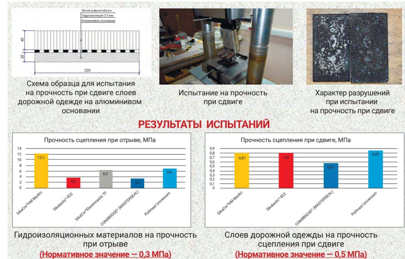
Рис. 6. Лабораторные испытания слоев дорожной одежды на прочность при отрыве и сдвиге
