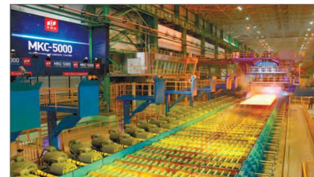
Рис. 1. Металлургический комплекс «Стан-5000» Выксунского завода ОМК
