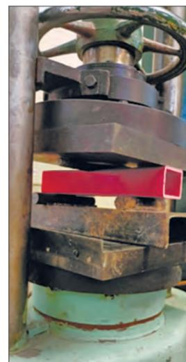
Рис. 1. Испытания элемента на сжатие
