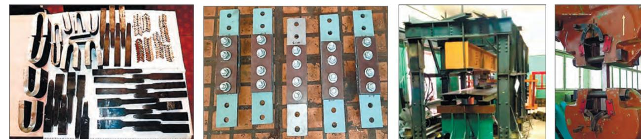
Рис. 2. Образцы из стали марки 10ХСНД в процессе и после проведенных испытаний
