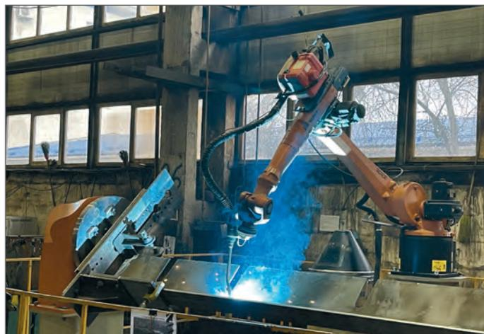
Качество выполнения сварных швов контролируют визуально-измерительным способом, методом ультразвуковой дефектоскопии, металлографическим исследованием макрошлифа и механическим испытанием контрольных образцов.
