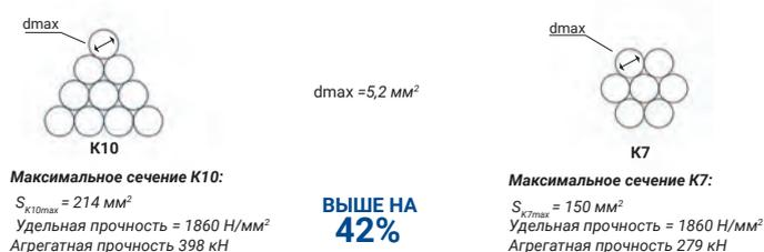
Рис. 4. Максимальный диаметр проволок для свивки канатов
