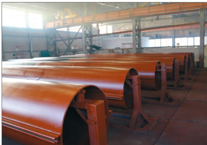
Рис. 1. Шпунт трубчатый сварной, общий вид
