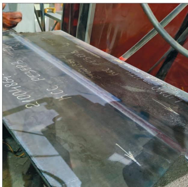
Рис. 6. Общий вид сварного соединения из стали марки 10ХСНД в термомеханически обработанном состоянии
