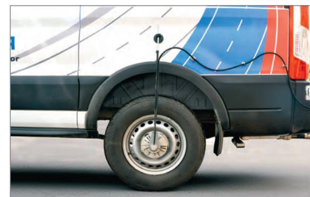
Рис. 3. Общий вид датчика пройденного пути, установленного на колесо дорожной лаборатории
