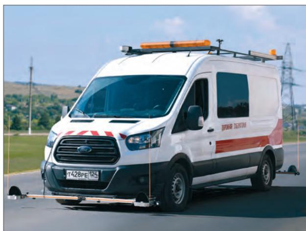
Рис. 1. Общий вид дорожной лаборатории с каналом «Освещенность»
