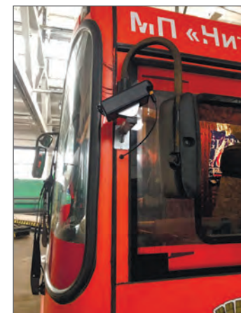
Рис. 2. Мобильный комплекс мониторинга на рейсовом автобусе. Нижний Новгород
