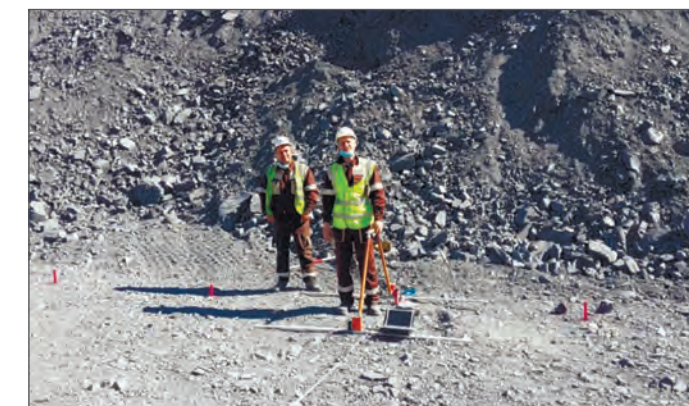
Рис. 2. Обследование горного карьера АО «Полюс Магадан» моноимпульсным георадаром «ГРОТ 12Н» с антеннами 2 м
