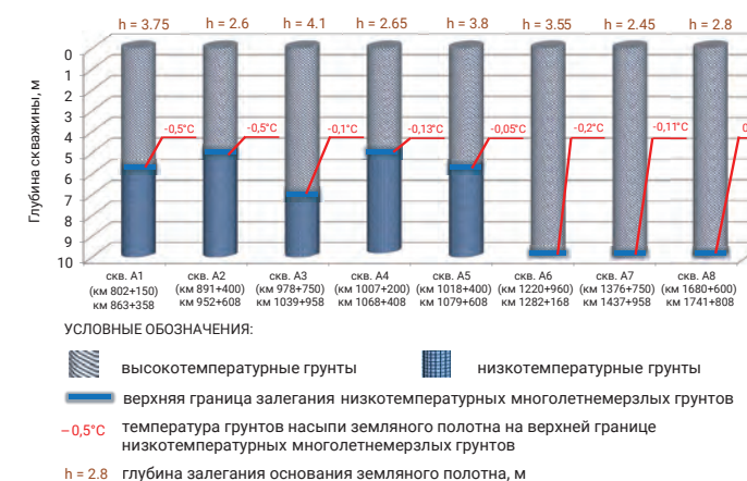
Рис. 2. Диаграмма изменения характеристик грунтов насыпи земляного полотна автомобильной дороги Р-297 «Амур» по результатам исследований, выполненных Институтом мерзлотоведения им. П.И. Мельникова СО РАН в 2012 г.
