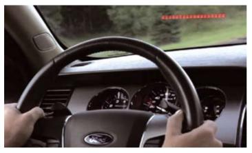
Рис. 2. Пример информирования водителя об опасности (резко остановившееся впереди транспортное средство) путем отображения сигнала на лобовом стекле — ярко-красной мигающей полоски
