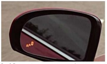
Рис. 4. Пример информирования водителя об опасности перестроения на боковом зеркале автомобиля
