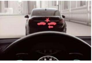
Рис. 3. Пример информирования водителя об опасности (резко остановившееся впереди транспортное средство) путем отображения сигнала на лобовом стекле — яркокрасного изображения силуэтов автомобилей
