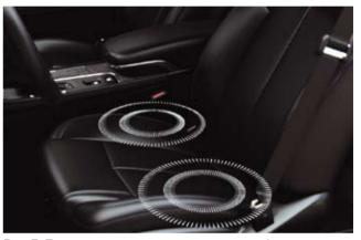
Рис. 5. Пример информирования водителя об опасности путем срабатывания вибродатчиков, встроенных в водительское сиденье
