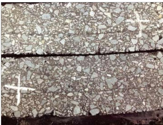
Рис. 3. Образцы-балочки с армированием георешеткой после испытания
