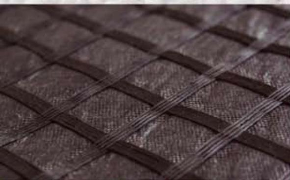
**Георешетка «УЛЬТРАНИТ АСФАЛЬТ»** применяется в качестве армирующего элемента в конструкциях дорожных и аэродромных покрытий, повышая упругие свойства асфальтобетона и увеличивая его сопротивляемость растягивающим усилиям при длительных и многократно прикладываемых нагрузках. Использование георешетки «УЛЬТРАНИТ АСФАЛЬТ» позволяет снизить толщину слоя асфальтобетонного покрытия до 20% и предотвратить распространение отраженных трещин.
