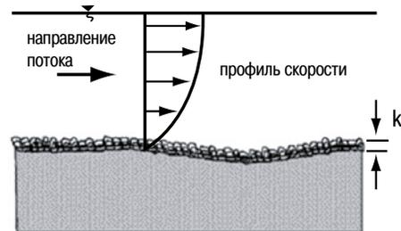
Рис. 3. Схема для коэффициента глубины
