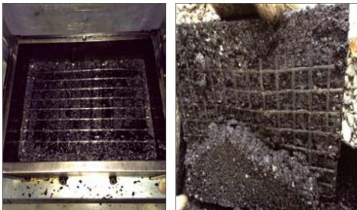
Рис. 1. Лабораторная укладка геосинтетических материалов между слоями асфальтобетона с последующим уплотнением вальцовым уплотнителем
