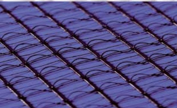
**Георешетка «УЛЬТРАНИТ 3D»** используется в качестве армирующего элемента при укреплении откосов и склонов. Благодаря естественному прорастанию корней растений сквозь сетчатую структуру георешетки, прочность склонов с годами возрастает. Такие сооружения могут служить практически неограниченное время.
