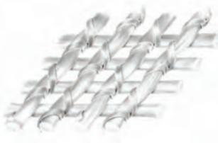
Рис. 5. Структура материала, изготовленного на основовязальном станке
