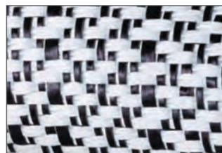
Рис. 4. Структура материала, изготовленного на ткацком станке
