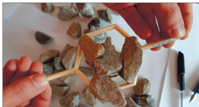
Рис. 1. Заклинка щебня в гексагональной ячейке диаметром вписанной окружности 60 мм и высотой поперечного сечения ребра 5 мм
